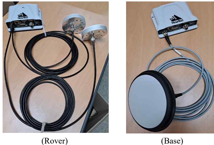
<그림 2> 비행 평가 모듈(Rover, Base)과 GPS 안테나 연결
