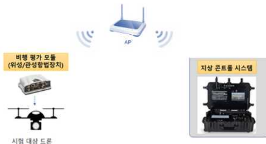
<그림 2> 비행 평가 모듈(Rover)과 지상 콘트롤 시스템간 무선 와이파이 연결
