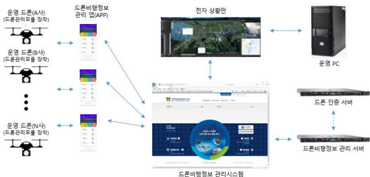
<그림 1> 산업용 드론 비행정보 관리시스템 구성도
