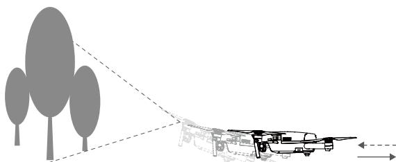
**⚠ 전방 및 하향 비전 시스템의 성능은 비행 중인 표면의 영향을 받습니다.** 방음 자재 위로 비행하는 경우에는 초음파 센서가 거리를 정확하게 측정하지 못할 수 있으며 부적합한 환경에서는 카메라가 제대로 작동하지 않을 수 있습니다. 기체는 GPS나 전방 및 하향 비전 시스템 중 하나를 사용할 수 없는 경우 자동으로 P 모드에서 ATTI 모드로 전환됩니다. 다음 상황에서는 기체를 작동시키는 데 상당한 주의가 필요합니다.
