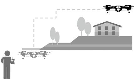
기체는 앞에서 장애물을 감지하거나 지면에 너무 가깝게 비행하고 있을 때 자동으로 속도를 조정합니다. 하지만 장애물 사이를 이동할 때 이 기능에 의존해서는 안 됩니다.
