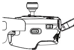
**P 모드(위치 조정):** P 모드는 GPS 신호가 강할 때 가장 잘 작동합니다. 기체는 GPS와 전방 및 하향 비전 시스템을 활용하여 스스로 위치를 찾고 자동으로 안정화하며 장애물 사이를 이동합니다. 이 모드에서는 TapFly 및 ActiveTrack과 같은 고급 기능이 활성화됩니다.
