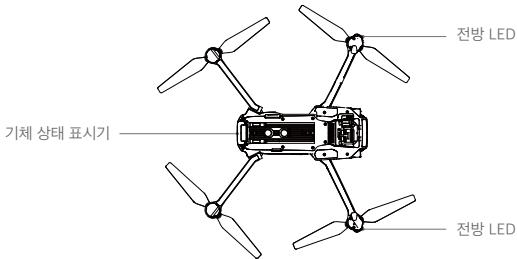
전방 LED는 기체의 방향을 나타냅니다. 전방 LED는 기체가 커질 때 기체의 전방(기수)을 나타내기 위해 빨간색으로 일정하게 유지됩니다(전방 LED는 DJI GO 4 앱에서 끌 수 있음). 기체 상태 표시기는 비행 컨트롤러의 시스템 상태를 알려줍니다. 기체 상태 표시기에 대한 자세한 내용은 아래 표를 참조하십시오.
